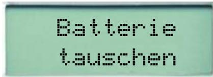
Zum Öffnen des Batteriefaches schieben Sie den Deckel des Batteriefachs mit dem Daumen nach links. Die Batterien können nun gewechselt werden. Bitte verwenden Sie nur Batterien folgenden Typs: Lithium-Zelle CR 2025. Es werden 2 Stück benötigt. Wir empfehlen folgende Hersteller: Toshiba, Panasonic und Maxell. Bei anderen Herstellern kann die Batterienutzungszeit wesentlich geringer sein.
