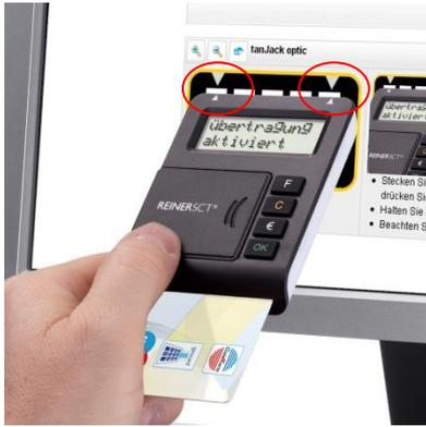
Halten Sie das Gerät mit der Rückseite vor die blinkenden Felder Ihrer Banking-Anwendung, bis das Gerät „**Übertragung erfolgreich**“ anzeigt.
