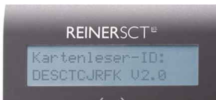
Anzeige der Chipkartenleser-ID (Anzeige erfolgt nur beim Drücken der @-Taste bzw. Zahnrad-Taste)
