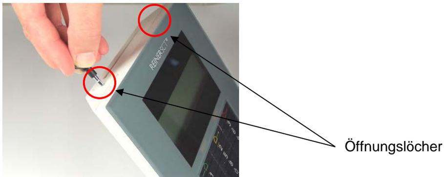
Um die Montage zu erleichtern, können Sie den Deckel von der Geräterückseite trennen. Dazu müssen Sie die Laschen an der Rückseite mit den beiden Daumen nach innen drücken und dabei die Rückseite nach vorne bewegen und somit aus der Arretierung lösen.
