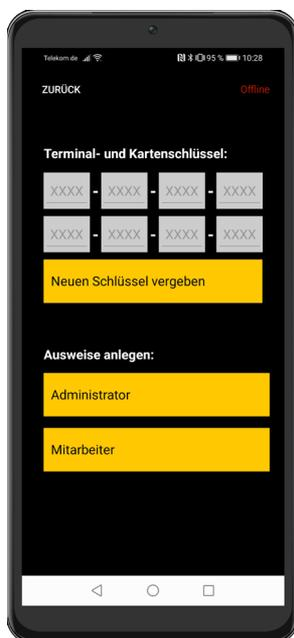
Der Terminalschlüssel dient der Authentifizierung und der verschlüsselten Kommunikation zwischen einem Terminal und den dazugehörigen RFID-Ausweisen. Somit wird sichergestellt, dass RFID-Ausweise eines anderen Systems keine Verbindung mit Ihrem Terminal herstellen können.
